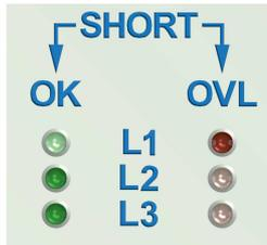
Los LED's rojos indican que el ICT 2.3 está sobrecargado en una de las fases (por ejemplo fase L1) y activa la función de **CORTOCIRCUITAR AUTOMATICAMENTE**.
