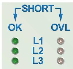
Los LED's verdes indican condiciones de operación normal. El ICT 2.3 está encendido y opera correctamente. Este indicador es válido para la fase individual.
